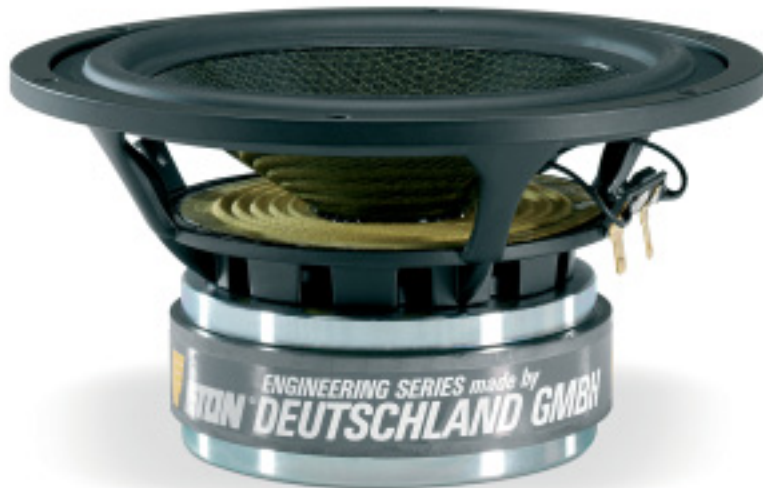
Nicht im Handel zu haben: nach Avalon-Spezifikationen modifizierter 18-Zentimeter-Tieftöner von Eton mit Nomex-Kevlar-Kompositmembran
